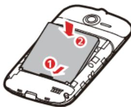
1. Coloque el borde identificado como **1** (donde están los contactos) en la parte inferior del compartimento de la batería.
