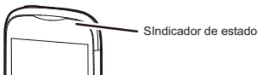
Verde: completamente cargada (cargador conectado).
